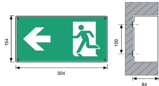
Bei wandbündiger Betoneinbaumontage kann das Gehäuse direkt in die Wandschalung eingelegt werden. Wir empfehlen, ein Holzstück von mind. 20 mm Dicke\* (auf die Innenmasse des Gehäuses 300 x 150 mm zugeschnitten) auf die Schalung aufzunageln. Das Gehäuse kann dann darüber aufgesetzt und mit Nägeln fixiert werden. Dadurch wird ein Verrutschen und Verformen des Leuchtgehäuses in der Wandschalung verhindert.
