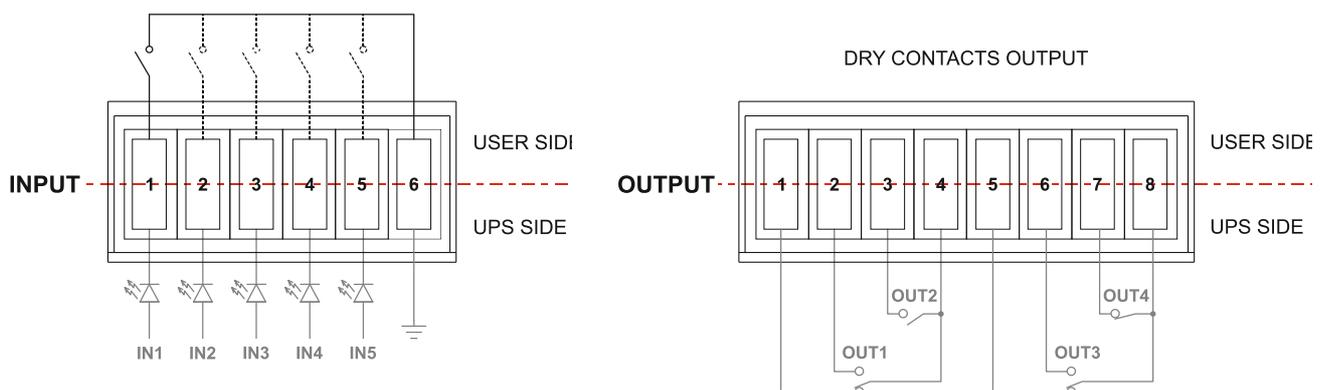
Bei Installation eines externen Wartungs-Bypasses oder Batterieschranks müssen die jeweiligen Hilfskontakte mit den richtigen Eingängen verbunden und entsprechend programmiert werden.
