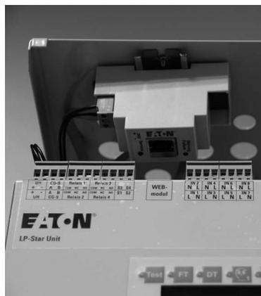
Platzierung des Webmoduls im Gehäuse
