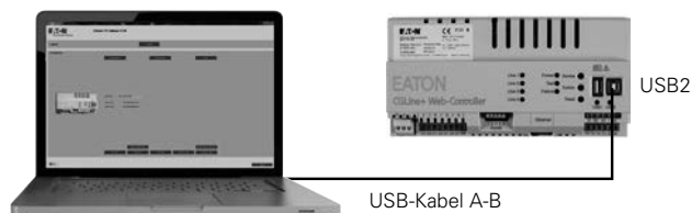
Abb. 4. Anschluss des Controllers zu einem Notebook mit CGLine+ PC-Software über USB A-B
