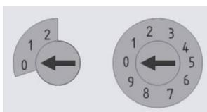
0 + 0 = Überwachung aus | *monitoring off*
