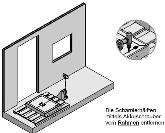
Die Scharnierhälften mittels Akkuschrauber vom Rahmen entfernen.
