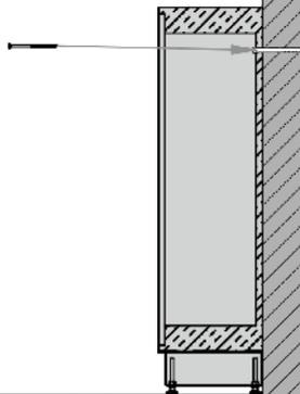
10 abschließende Endkontrolle ob Brandschutzgehäuse in Waage steht
