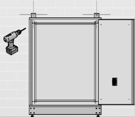
9 Brandschutzgehäuse an Wand befestigen (Durchsteckmontage)
