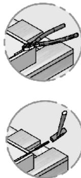
Die Stiftkappe mit einer Zange entfernen. Der Stift zwischen den Scharnierhälften wird mittels Dorn herausgeschlagen.
