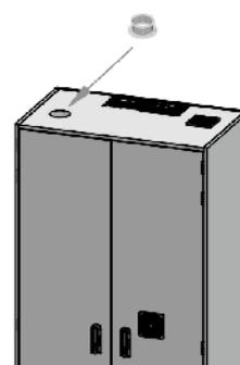
Anschließend vormarkierte Löcher in die Oberseite des Deckels bohren (ca. 10 mm tief).
