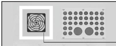
3. Positionieren Sie den Lüfter möglichst mittig über der Lüftungsöffnung.
