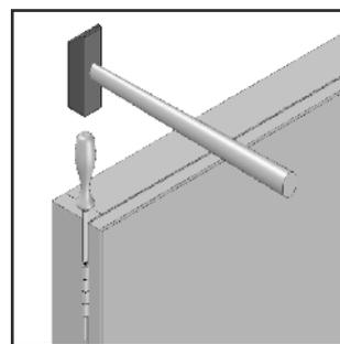
3. Die Türen samt Scharniere vom Rahmen lösen und behutsam zwischenlagern.
