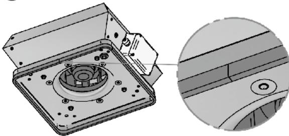
Den Dichtgummi auf die Kante des Ventilator-Montageblechs ohne Zugspannung aufstecken.
