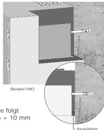
4. Die genaue Bohrtiefe ist abhängig von der Dübellänge und ist wie folgt zu ermitteln: Erforderliche Bohrtiefe = Dübellänge - Bauteildicke + 10 mm
