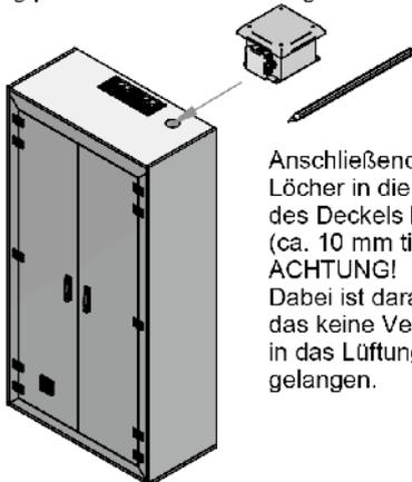
Anschließend vormarkierte Löcher in die Oberseite des Deckels bohren (ca. 10 mm tief).
