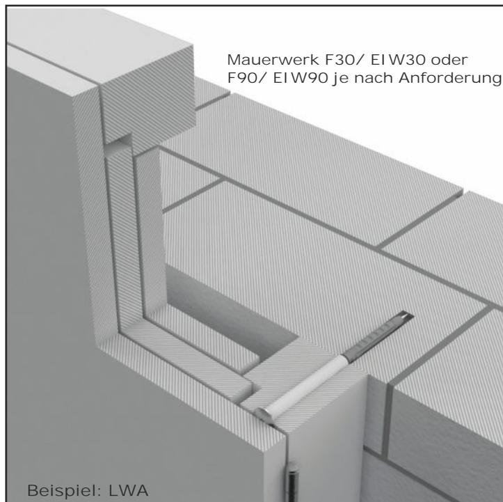
2. Befestigung durch mitgelieferte Injektionsdübel. Der Befestigungsbolzen muss bündig am Rahmen der Wandvorsatztür anliegen, da die Türen sonst nicht mehr geschlossen werden können.
