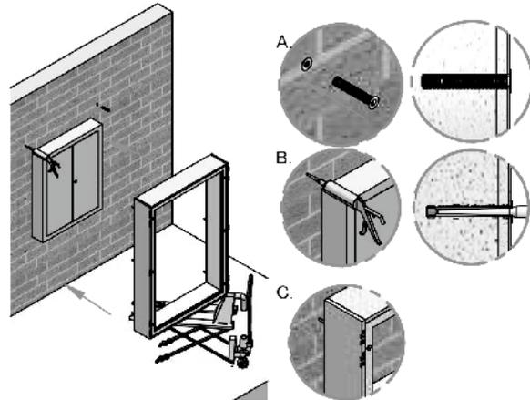
**9** LWÜ mit durchgesteckten Gewindestangen an die Gebäudewand schieben.
