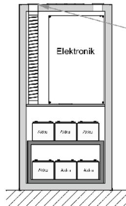
Montage des Bundkragens oberhalb des Entlüftungsschlauchs
