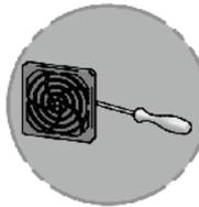
Abdeckung und Schutzmatte mittels Hebel, vorsichtig entfernen.
