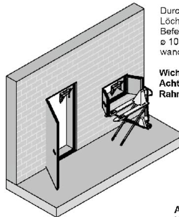
Durch die vorgebohrten Löcher im Rahmen die Befestigungsbohrungen ø 10 mm in die Massivwand übertragen.
