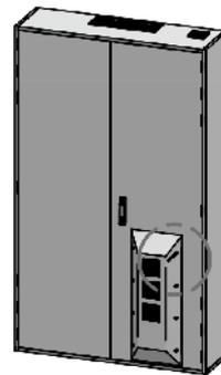
Im Anschluss wird der Lüfter RLS 230 V an das Brandschutzgehäuse angehalten und die Bohrungen mittels Stift auf den Türflügel übertragen.
