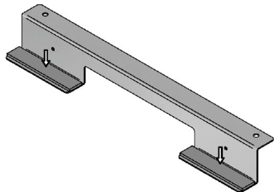
Montagewinkel auf den Innenseiten welche auf dem DVS-Ventilator auf liegen, mit den beiliegenden Gummistreifen bekleben.
