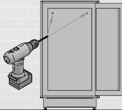
9 Brandschutzgehäuse an Wand befestigen (Durchsteckmontage)
