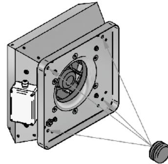
Die auf der Unterseite im Ansaugbereich vorhandenen vier Montagebohrungen mit den Gummiverschlussstopfen verschließen.
