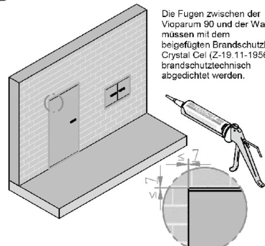
Die Fugen zwischen der Vioparum 90 und der Wand müssen mit dem beigefügten Brandschutzkitt Crystal Cel (Z-19.11-1956) brandschutztechnisch abgedichtet werden.
