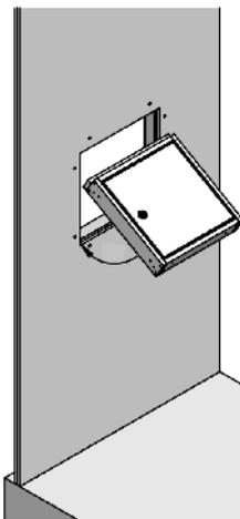
Die LEG-R 30 wird von unten nach oben schiebend in die Öffnung eingebracht.
