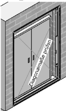
B. in die vorgebohrten Löcher im Rahmen die dafür vorgesehenen Dübel (Dübelhülse und Spezialschraube) einbringen (Durchsteckmontage)
