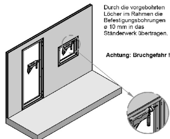
Durch die vorgebohrten Löcher im Rahmen die Befestigungsbohrungen ø 10 mm in das Ständerwerk übertragen.
