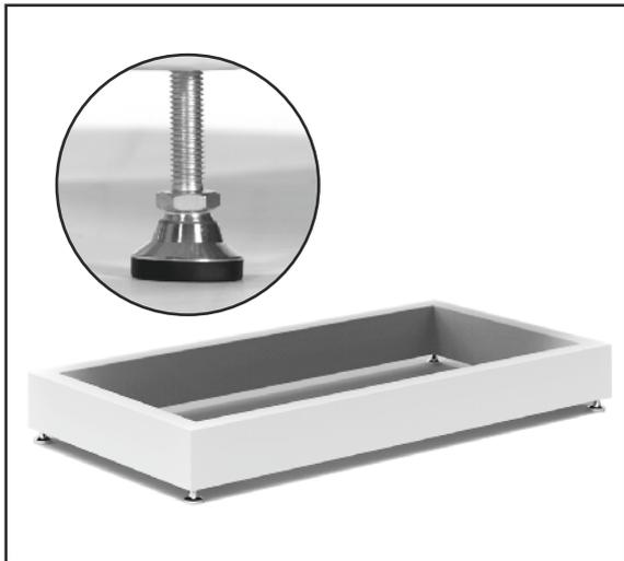
Die Sockelhöhe beträgt 100 mm und ist mittels beiliegender Nivellierfüße von 125 bis 150 mm höhenverstellbar. Die Abmessungen des Metallsockels in der Breite und Tiefe ergeben sich aus dem Verteileraußenmaß.
