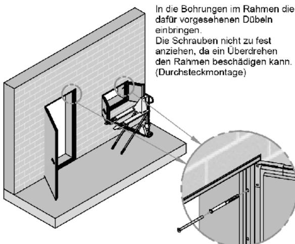
In die Bohrungen im Rahmen die dafür vorgesehenen Dübel einbringen.
