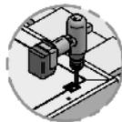
Die Scharnierhälften mittels Akkuschrauber vom Rahmen entfernen.
