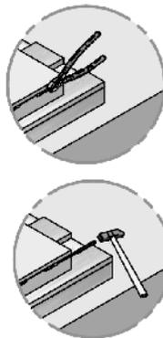
Die Stiftkappe mit einer Zange entfernen. Der Stift zwischen den Scharnierhälften wird mittels Dorn herausgeschlagen.
