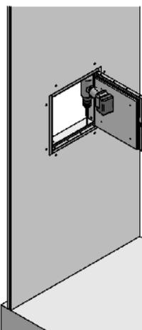
Befestigungsbohrungen mittels eines geeigneten Bohrers entsprechend Pkt. 3.2.2.4 der abZ im Rahmen, unter Beachtung des Profils, vornehmen.
