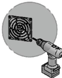
Alle 4 Schrauben lösen und entfernen.
