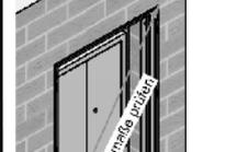
B. in die vorgebohrten Löcher im Rahmen die dafür vorgesehenen Dübel (Dübelhülse und Spezialschraube) einbringen
