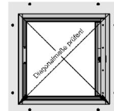
Die Klappe der LEG-R 30 vorsichtig öffnen, gleichzeitig den Rahmen mit den Händen fixieren. Die Putzkante von 2 mm an Rahmen und Tür ragt über die Schachtwand hinaus.
