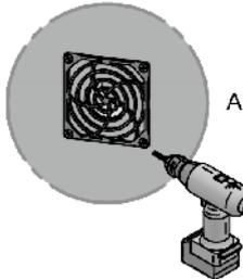
Alle 4 Schrauben lösen und entfernen.
