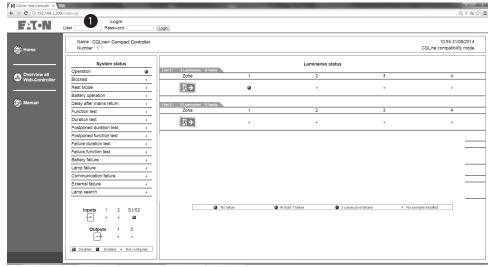
Das Admin-Konto erlaubt einen vollen Zugriff zum CGLine+ Web Compact Controller, z.B. um einen Funktionstest zu starten. Das Userkonto erlaubt nur eine Anzeige der Statusmeldungen vom Controller und den angeschlossenen Leuchten. Es wird empfohlen aus Sicherheitsgründen, das Passwort für das Admin-Konto zu ändern. Dieses wird im Kapitel 7.12 Allgemeine Geräte-
