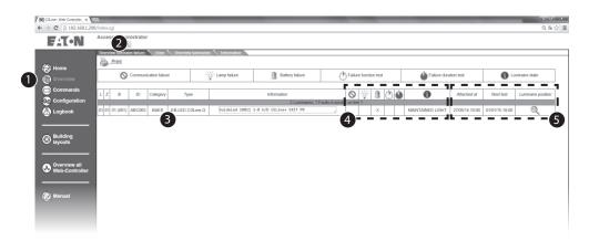
Im Menü "Übersicht" 1 und Register "Übersicht Leuchtenfehler" 2 werden alle Leuchten mit einer Störung angezeigt 3:
