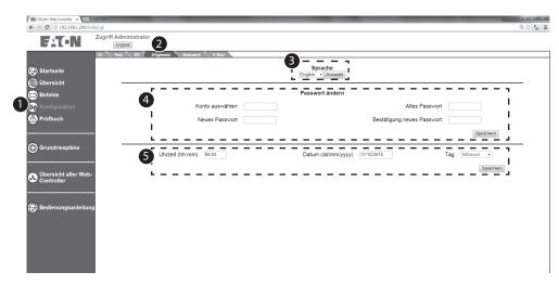
Damit die Tests zeitrichtig ausgefhrt werden, und die Prüfbucheinträge zeitlich korrekt sind, ist es notwendig, nach Inbetriebnahme das Datum und die Uhrzeit im CGLine+ Web Compact Controller richtig einzustellen 5.
