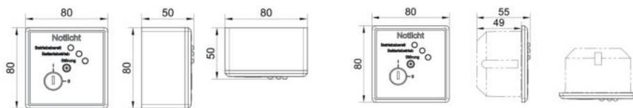
**N00.100003** | 3-Phasenüberwachung | (Masse in mm)
