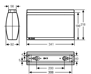
28021 LED CGLine+ mit Deckenbefestigung (Zubehör) 28021 LED CGLine+ with ceiling mounting (accessory)
