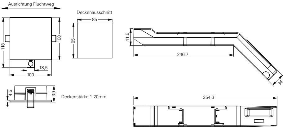
Bei Einbau durch Deckenausschnitt erforderliche Höhe in Zwischendecke: 150 mm
