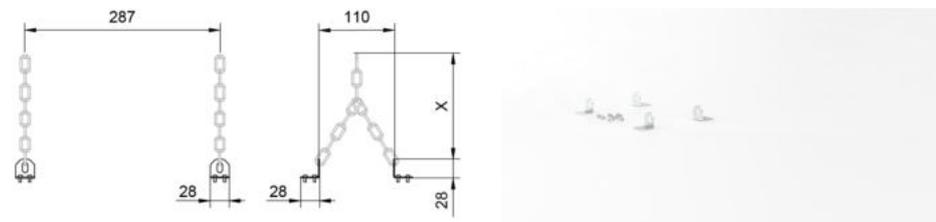
**L04.100881** | ROBUSTOX32 Seil | Seilset exklusive Befestigungssatz (Masse in mm)
