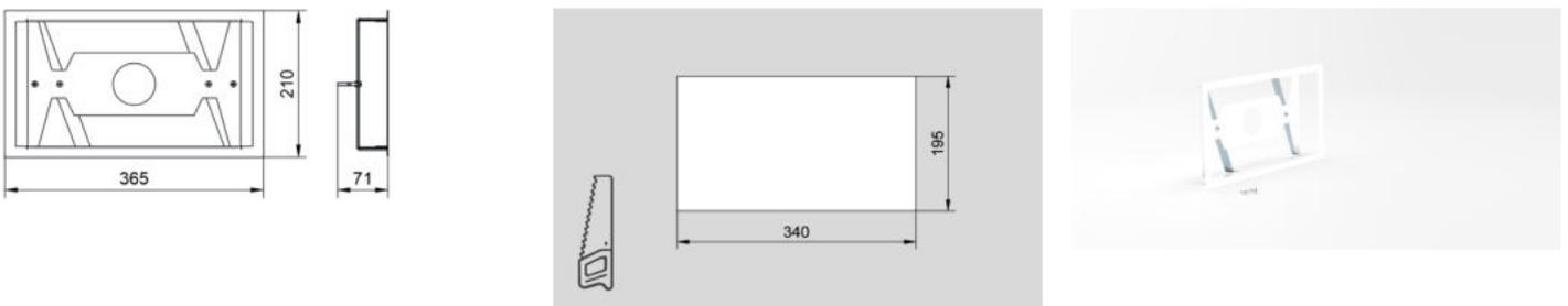
**L04.100880** | ROBUSTOX32 Kette | Befestigungssatz für Kettenabhängung (Masse in mm)
