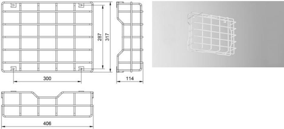
**L04.100877** | ROBUSTOX32IP65 Set | 2 Halteplatten RAL 9003, Einlegedicht., 1x Anbauverschr. M20
