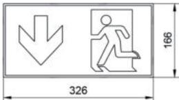
**L04.100872** | Scheibe zu ROBUSTO EX X32/X32-2.PARAMETR | PMMA-Scheiben, EK 32m, andere Pfeilrichtungen parametrierbar (Masse in mm)
