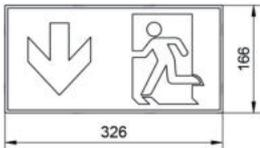
**L04.100872** | Scheibe zu ROBUSTO EX X32/X32-2.PARAMETR | PMMA-Scheiben, EK 32m, andere Pfeilrichtungen parametrierbar (Masse in mm)
