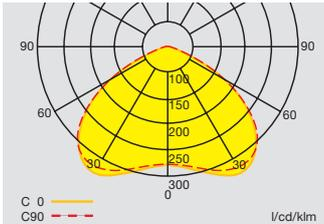
Messebene 0,02 m, Wartungsfaktor WF = 80 %, Batteriebetrieb, Abstände in m
