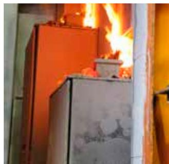
Test in caso di incendio per verificare l'integrità di funzionamento.
