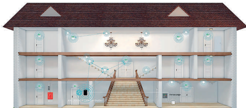
Das CMR-System kann flexibel positioniert werden und benötigt lediglich eine 230 VAC Netzversorgung. Die Kommunikation mit den Leuchten erfolgt per Funk über eine sichere IPSec-Verschlüsselung. (Bild: ALMAT)
