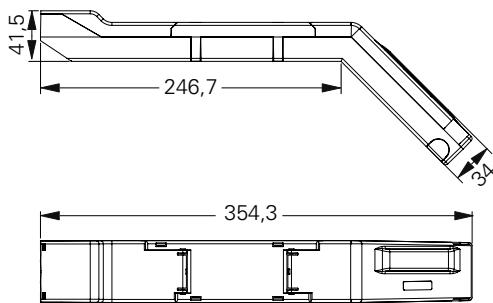
Bei Einbau durch Deckenausschnitt erforderliche Höhe in Zwischendecke: 150 mm
