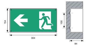
Bei wandbündiger Betoneinbaumontage kann das Gehäuse direkt in die Wandschalung eingelegt werden. Wir empfehlen, ein Holzstück von mind. 20 mm Dicke\* (auf die Innenmasse des Gehäuses 300 x 150 mm zugeschnitten) auf die Schalung aufzunageln. Das Gehäuse kann dann darüber aufgesetzt und mit Nägeln fixiert werden. Dadurch wird ein Verrutschen und Verformen des Leuchtengehäuses in der Wandschalung verhindert.
